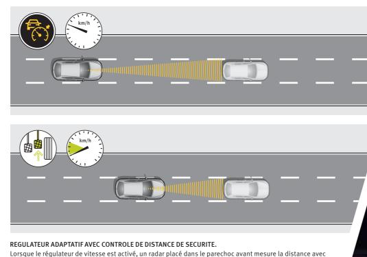
Lorsque le régulateur de vitesse est activé, un radar placé dans le parechoc avant mesure la distance avec le véhicule qui vous précède (jusqu'à 200m) et ajuste automatiquement votre vitesse pour maintenir la distance de sécurité nécessaire.
